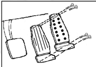
Die Kupplungs- und Bremspedalabdeckung montieren Sie wie folgt. Schieben Sie die Abdeckung von unten über die Pedalplatte. mit einem kleinen Schraubendreher hebeln Sie den Gummi über die Pedalplatte.
