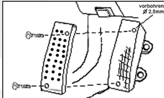
Die Gaspedalplatte wird auf das Gaspedal gelegt und Befestigungslöcher markiert. Mit den im Lieferumfang enthaltenen Schrauben (4x12) wird die Platte befestigt.
